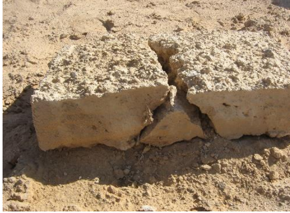
شكل رقم (9): طوبة تحوي شوائب كبيرة الحجم
