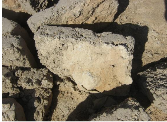
شكل رقم (13): طوبة بأبعاد غير منتظمة لعدم استواء الأرضية اثناء الاعداد
