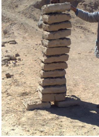
شكل رقم (31): اختبار التحميل للطوب
