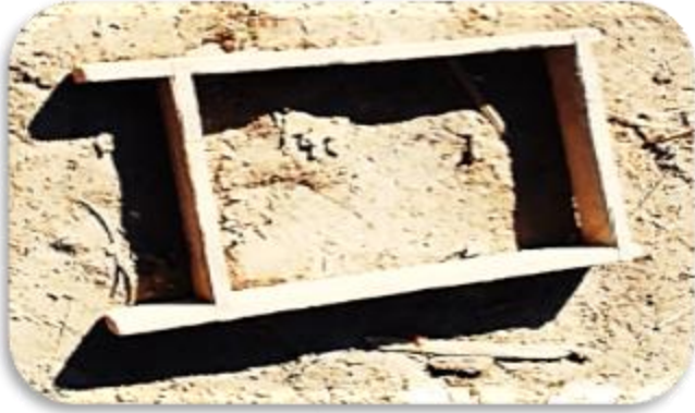
شكل رقم (5) صورة للقالب الخشي الذي يستعمل في تشكيل الطوب اللبن.
