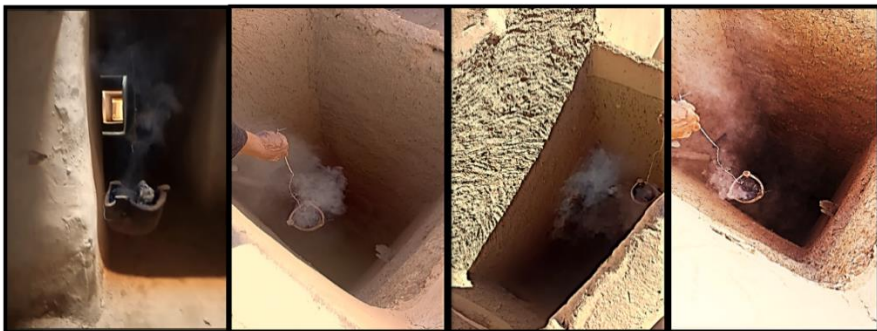
شكل رقم (37) بعض الصور للتجربة التي قمنا بها لمعرفة مدى تأثير الملاقف على حركة التيارات الهوائية داخل المدينة.
