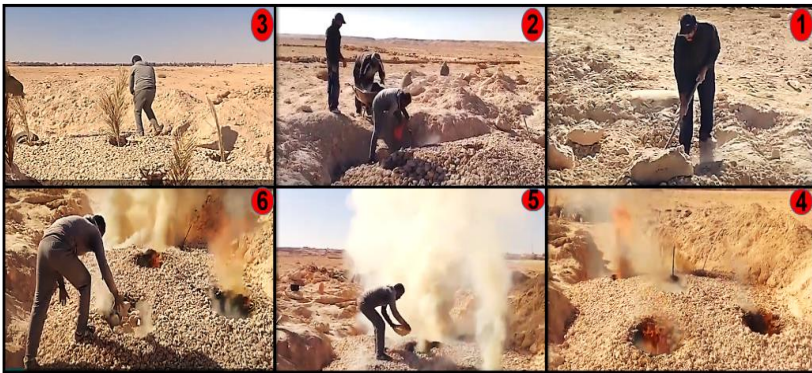
شكل رقم (26) صور توضح طريقة استخراج وحرق الجبس المحلي بالطريقة التقليدية في مدينة غدامس.
