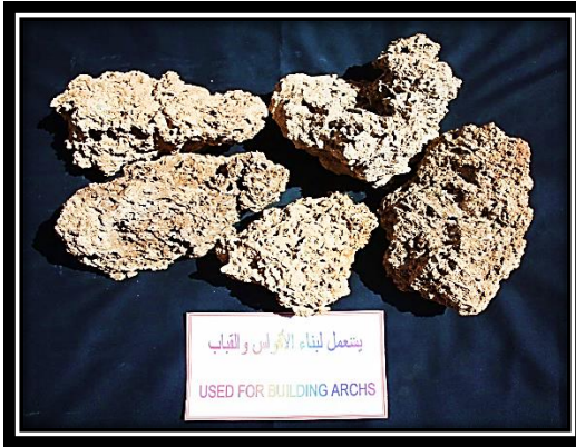
شكل رقم (10) صورة لنوع من الحجارة المسامية المعروف محلياً (أكرشو)
