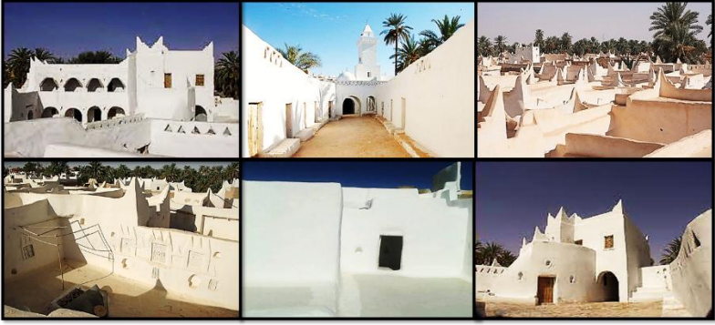
شكل رقم (28) صور توضح استخدام اللون الأبيض الذي له دور في عكس أشعة الشمس وتقليل الكسب الحراري.
